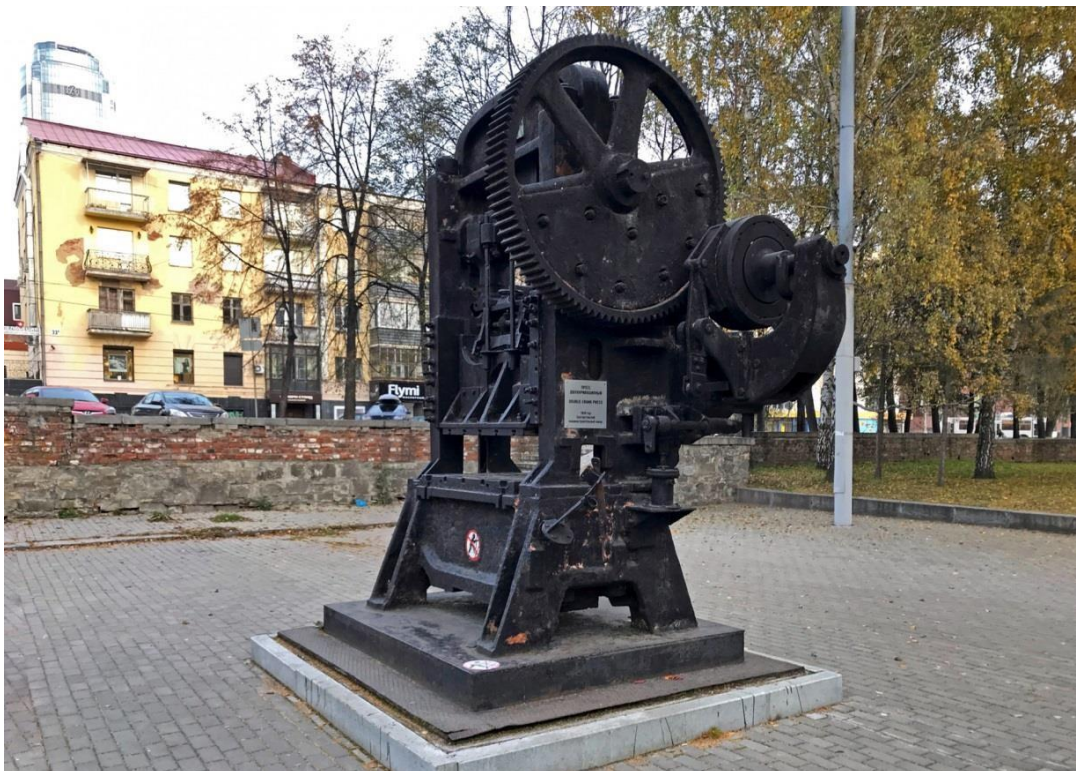
8. Пресс двухкривошипный, 1930, Златоустовский машиностроительный завод (Челябинская обл., г. Златоуст). Машина для штамповки различных деталей.
