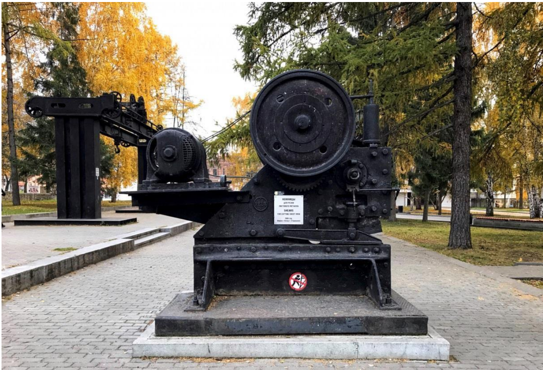
6. Ножницы для резки листового металла, 1908 год, завод «Пельс» (Германия). Машина с самым очевидным предназначением: нарезка листов металла.
