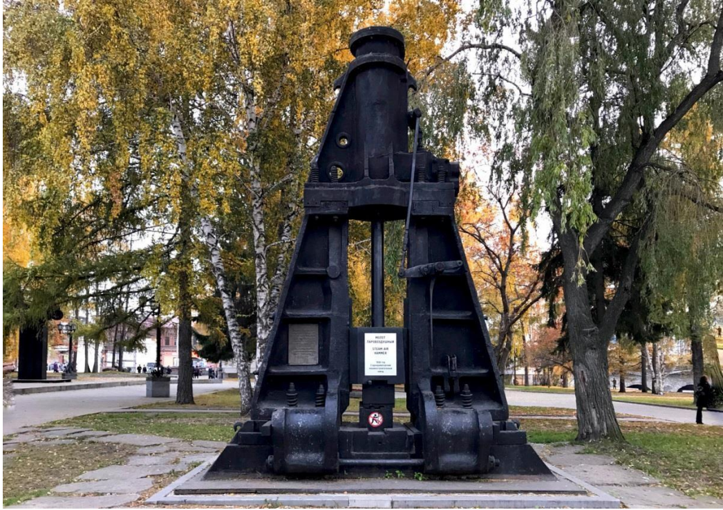
6. Ножницы для резки листового металла, 1908 год, завод «Пельс» (Германия). Машина с самым очевидным предназначением: нарезка листов металла.
